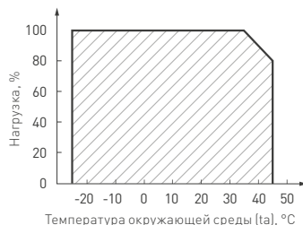
Рис. 2. Максимальная допустимая нагрузка, % от мощности источника
