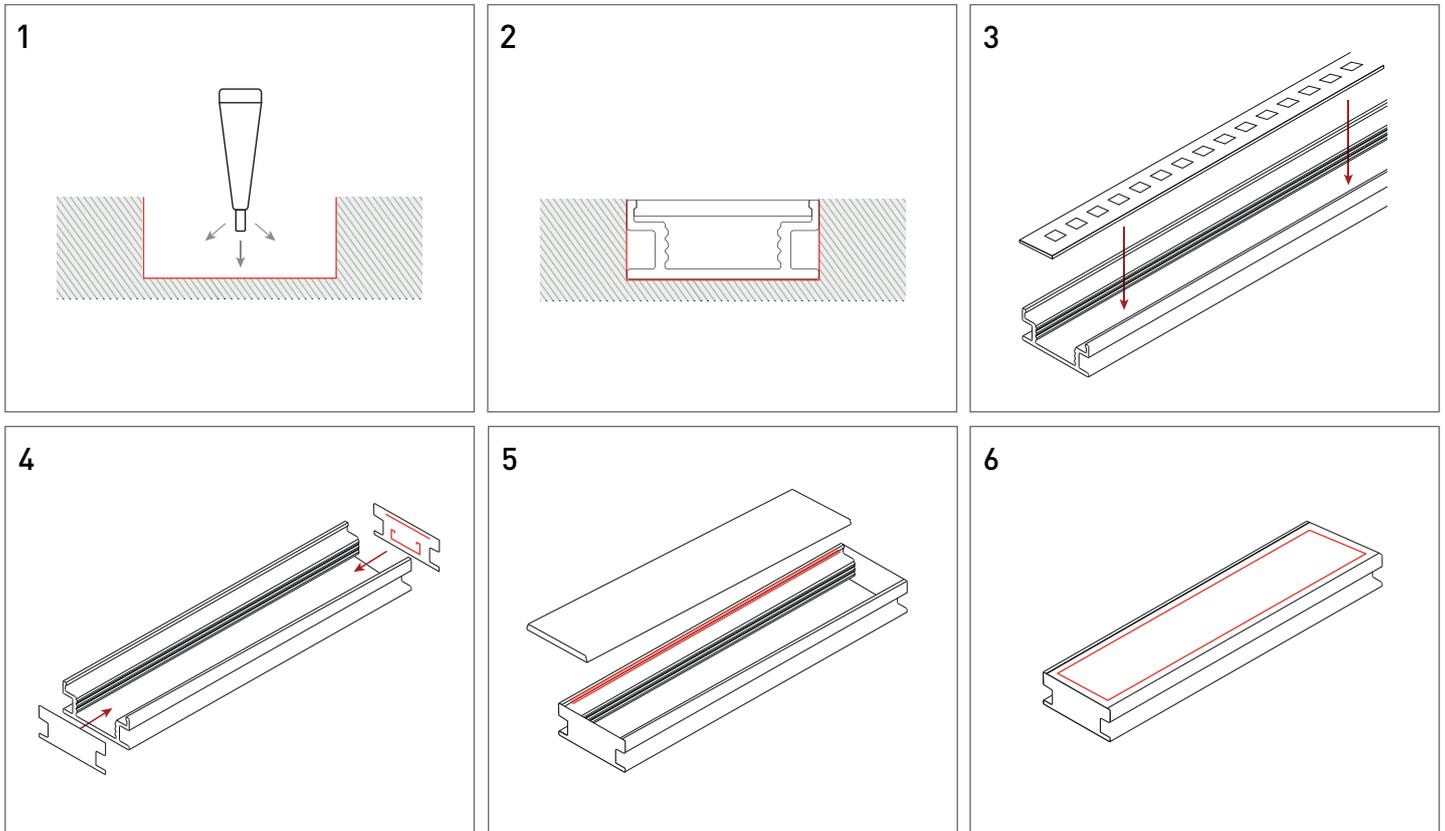
1. Выполните паз в полу по ширине и высоте профиля. Нанесите в паз силиконовый клей.
